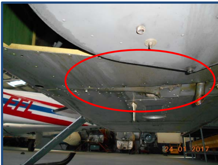
Fotografía No.: 06 Daño en la lámina parte inferior del fuselaje lado derecho.
