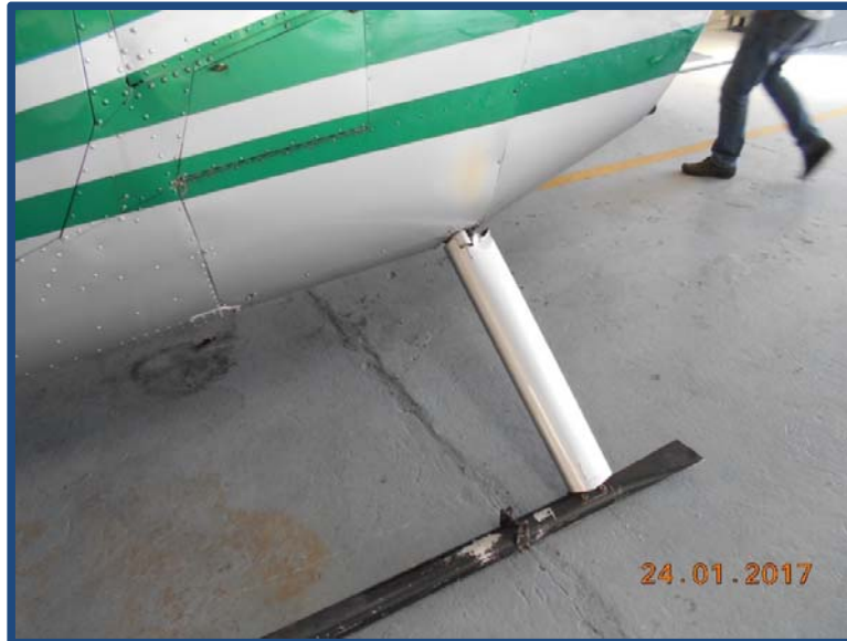
Fotografía No.: 09 Vista del daño en el tren de aterrizaje lado izquierdo.
