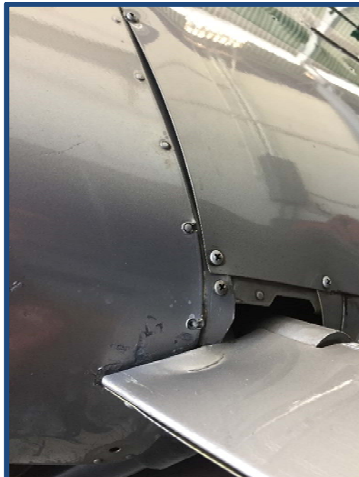
Fotografía No.: 16 Vista de la separación de las láminas y daño a soporte del tren de aterrizaje.
