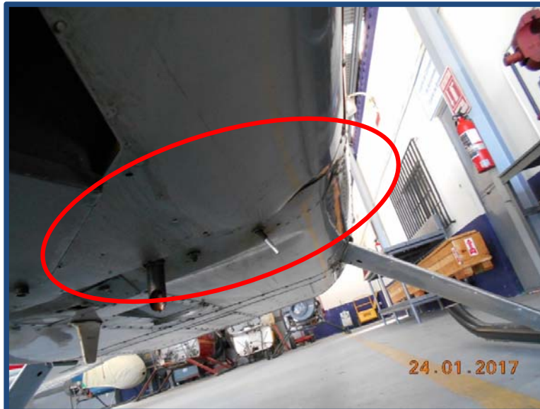
Fotografía No.: 05 Daño en la lámina parte inferior del fuselaje lado derecho.
