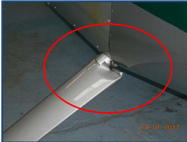
Fotografía No.: 07 Daño en soporte del tren de aterrizaje.
