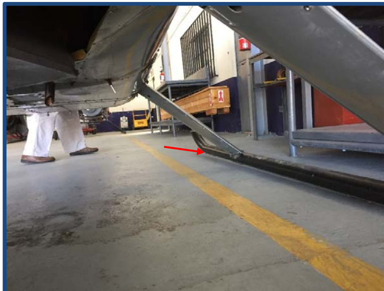
Fotografía No.: 12 Vista de la separación de la superficie del suelo y del skid.
